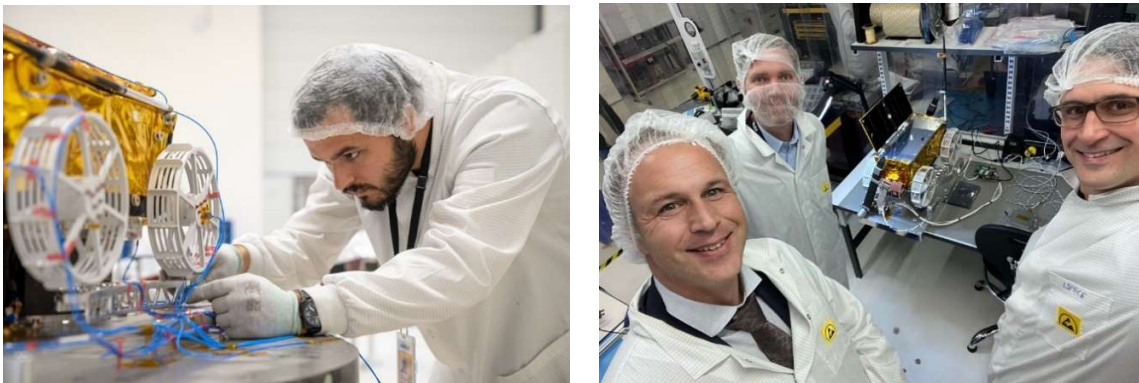
(左)ispace EU のエンジニアがマイクロローバーの環境試験の準備をする様子
