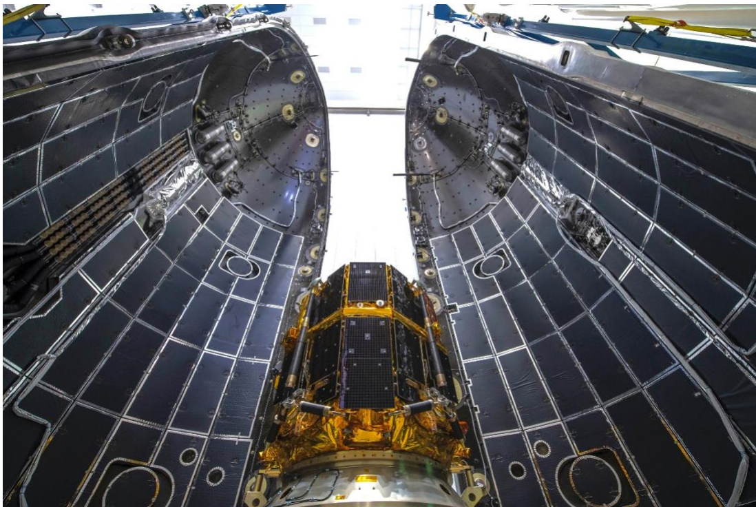
Falcon9 ロケットのフェアリングに搭載作業中のランダー
