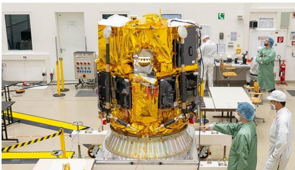
組立が完了したランダーのフライトモデルの様子（ドイツの IABG 宇宙試験施設にて）
